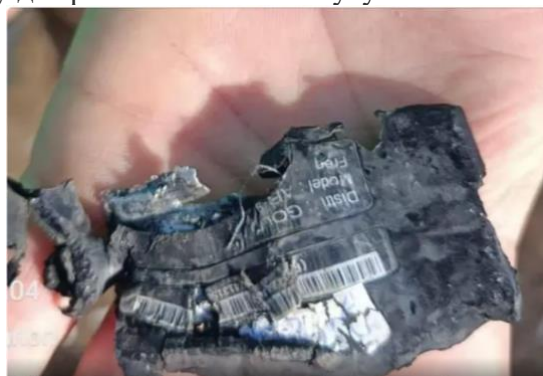
Рисунок 1 – Залишки пейджера, власник якого є член «Хезболли», після вибуху його елементів живлення (літій-іонних акумуляторів)
